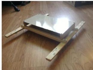
Рисунок 4 - Деревянный каркас и корпус робота
