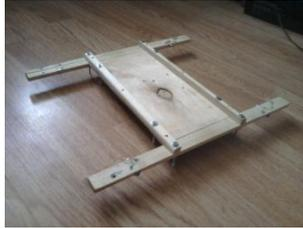
Рисунок 3 – Деревянный каркас робота
