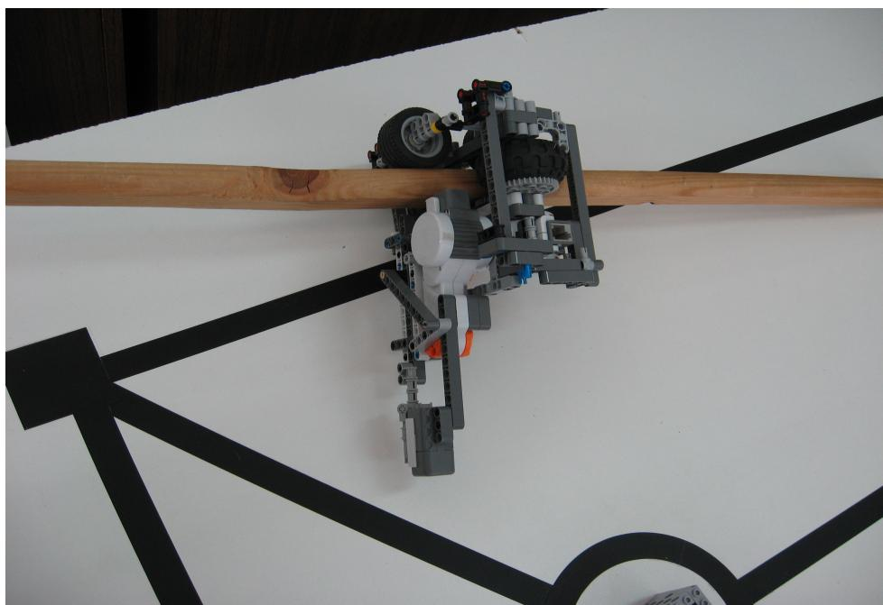
Перемещаясь по перпендикулярной балке сканер и захват движутся относительно поля вдоль оси ОХ. Сканер производит обход игрового поля и анализ текущей ситуации. Захват служит для перемещения шашек по полю.
